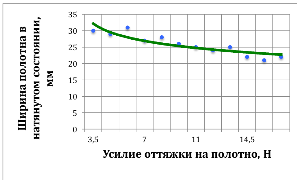
Рисунок 3 - График зависимости ширины полотна на машине в натянутом состоянии от силы оттяжки
